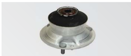
Coupelle d'amortisseur avec roulement intégré
